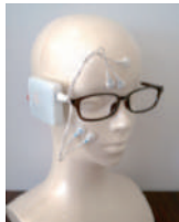
筋電計測によるウェアラブル感情価センシング装置試作品
