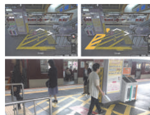
駅のホーム床ゼブラエリアの違いによる滞留人数・時間調査実験
